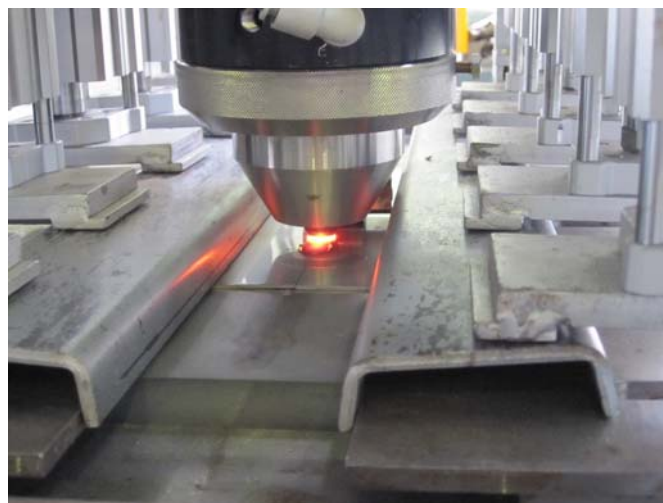
摩擦攪拌接合中の状態
